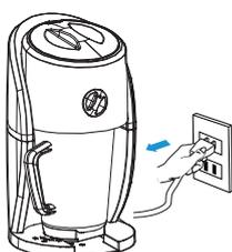
不使用時請務必拔起電源插頭不使用時仍有部份在通電狀態，會因絕緣劣化或漏電而造成火災。
