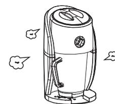
使用刨冰機請注意禁止加入冰糖、核桃殼...等硬質食材，避免刀組損壞
