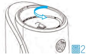
4. 將攪拌桿插在冰沙杯底固定軸上。
