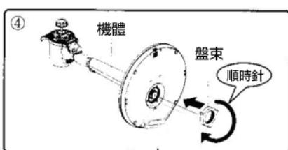
4. 請將拆下的盤束與完成組合的盤腳下方螺牙處結合，並以順時針旋轉鎖緊，如圖 4 所示。
