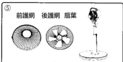
5. 請將組合完成的機體直立置放，再進行護網與扇葉的組裝程序，如圖 5 所示。
