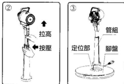
3. 管組與腳盤組合時，依照定位部的位置將管組與腳盤完成定位：在組裝時，請勿壓到內配線，對於有預留的內配線，必須置於管組或腳盤內，如圖 3 所示。
