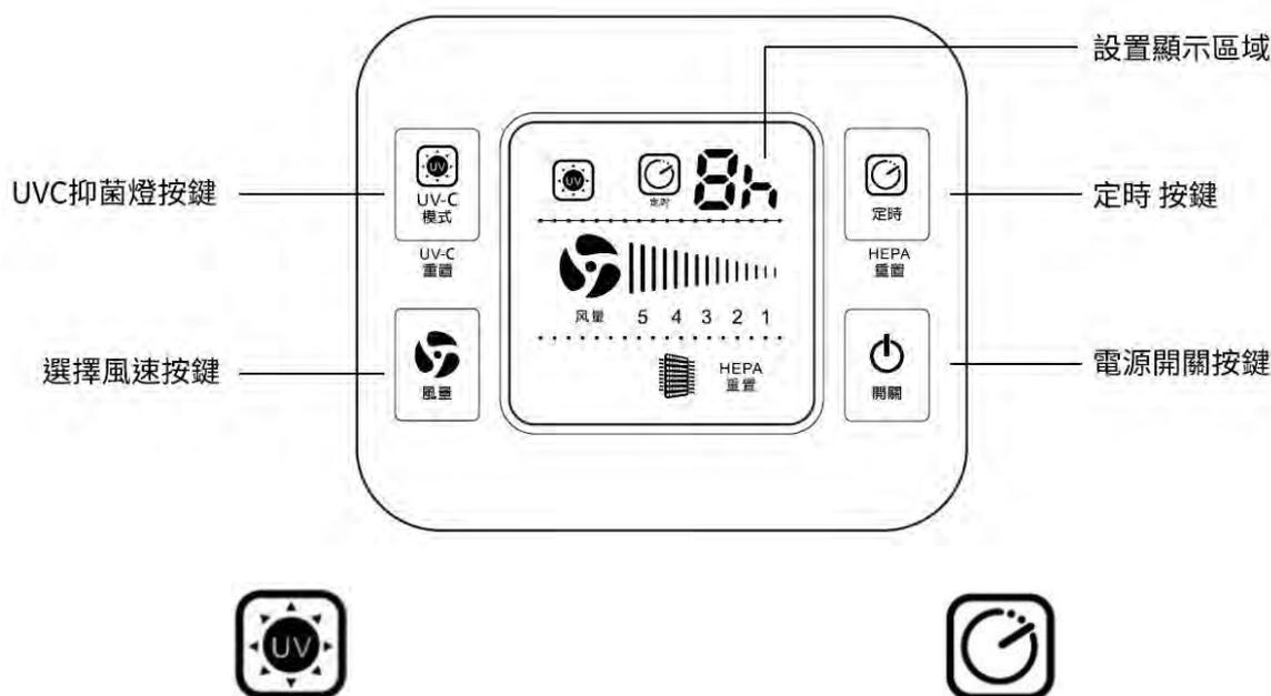
任何工作模式按下此鍵，蜂鳴器響，紫外線燈開始啟動，UV 指示環亮，再按一下即關閉。當紫外線燈須要更換時，LED 螢幕上 UV 圖示會以 0.5 秒頻率閃爍，提醒使用者做更換。更換完畢後，請長按本鍵三秒，蜂鳴器響後，LED 螢幕上 UV 圖示會停止閃爍，回到正常工作狀態。
