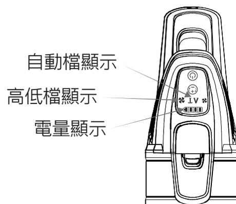
**高低檔模式：**當機器處於手動擋模式（手動按高低檔按鈕調檔），一檔模式，AT燈左邊的白色燈亮起；二檔模式，AT燈右邊的白色燈亮起；三檔模式，AT燈左右的白燈同時亮起。
