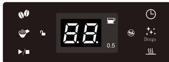
※每完成一次咖啡製作後，機器自動轉入保溫狀態，清潔指示燈 (
